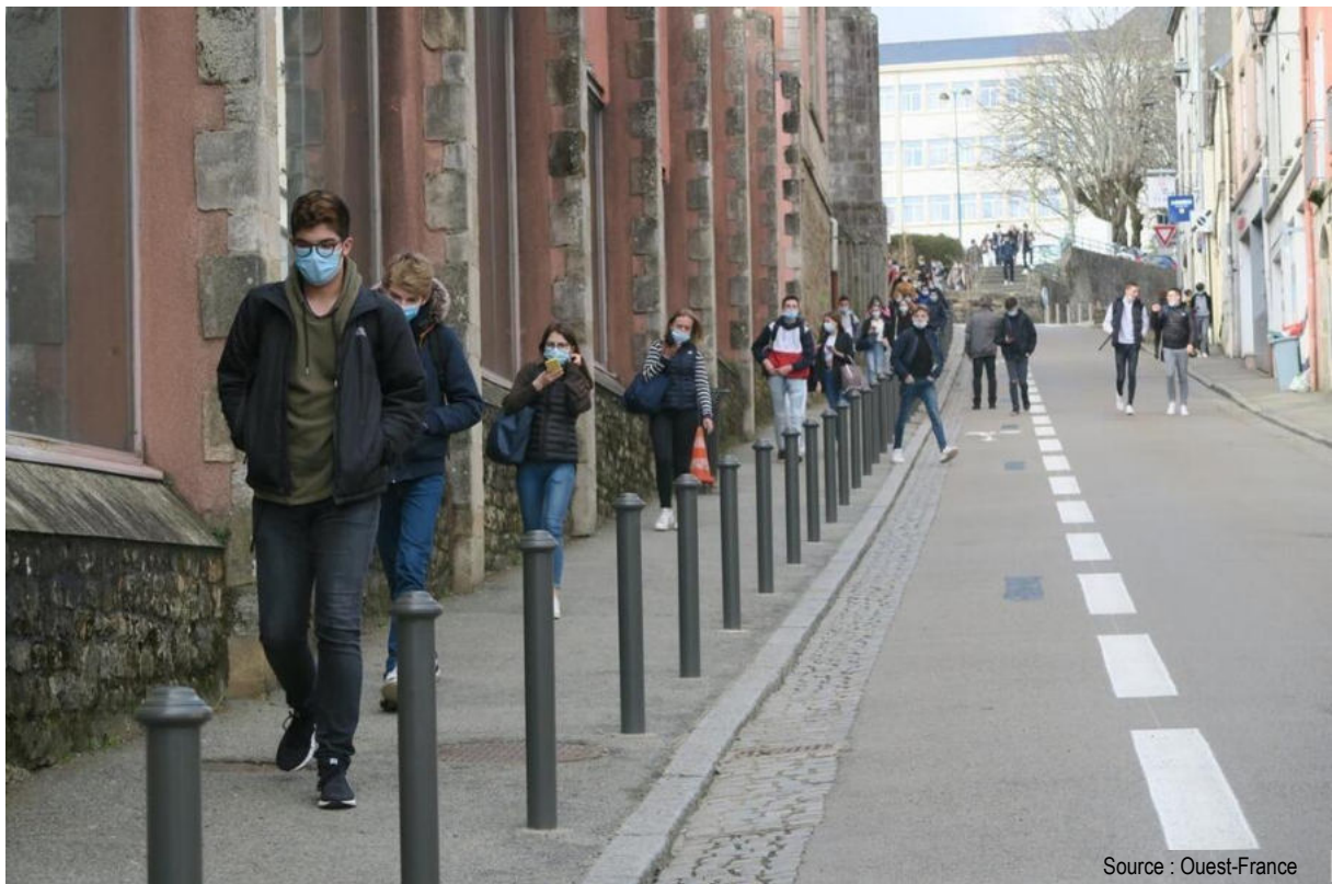
Sécurisation des piétons sur le trottoir par l'utilisation de poteaux
