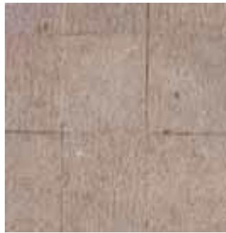
Pavé en granit : Matériau imperméable ou perméable. Possibilité de rendre la surface revêtue perméable par l'utilisation de joints perméables
